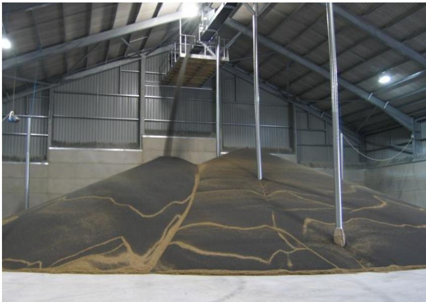
Pile-Dry Belüftungssäulen bilden das schnellste Niedrig-Volumenstrom-Kühlsystem und das einzige System dieser Art zum Trocknen von Getreide. Aufgrund der in England durch die Landwirtschaftsorganisation HGCA und das staatliche Untersuchungsamt CSL durchgeführten Forschungen können Sie sicher sein, dass Pile-Dry Belüftungssäulen Sie dabei unterstützen, Ihre Qualitätsziele bei der Lagerung zu erreichen.
