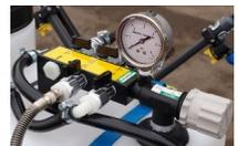
**Tank mit Ventilblock, Druckregulierung, Rührwerk, Filter und Steuerventil für jede Gestängesektion und Handwaschlanze.**
