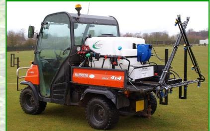
200-600 Liter-Tank - angehängt, montiert oder fahrzeugunabhängig
