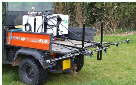
MINI-Spritze fahrzeugunabhängig mit anpassbarer Gestängebefestigung
