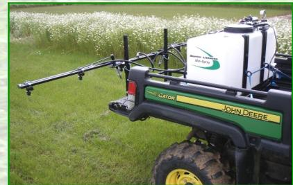
70 und 125 Liter-Tank - angehängt, montiert oder fahrzeugunabhängig
