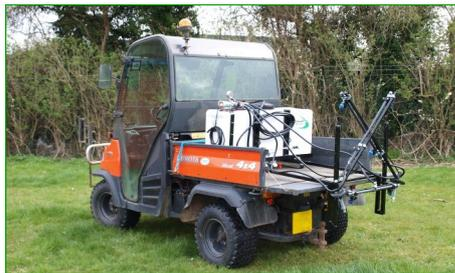
Die MINI-Spritze fahrzeugunabhängig 125 l Tank sitzt fest auf dem Montageboden des Kubota RTV
