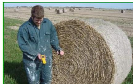
Zeigt die Feuchtigkeit von Heu- und Strohballen sofort an · 600mm lange Messsonde dringt bis in die Mitte selbst großer Ballen ein
