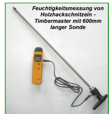
Feuchtigkeitsmessung von Holzhackschnitzeln - Timbermaster mit 600mm langer Sonde
