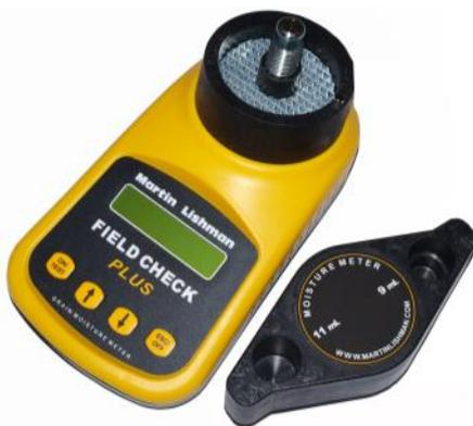
**Field Check<sup>PLUS</sup>** ist ein Messgerät für gemahlenes Getreide mit zwei verschiedenen in den oberen Bereich des Mahlwerks eingelassenen Messbechern. Das Display zeigt automatisch an, welche Probengröße entsprechend dem ausgewählten Erntegut anzuwenden ist. Nach dem Mahlen der automatisch festgelegten Menge wird das Ergebnis der Getreidefeuchtemessung umgehend angezeigt.
