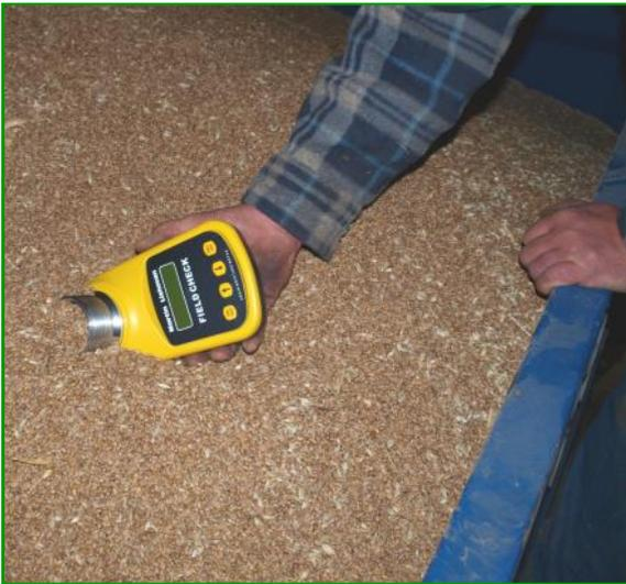
Field Check ist ideal für die Überprüfung von Anhängern vor der Einlagerung
