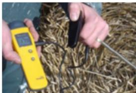
**Protimeter Balemaster** – mit einer 600 mm langen Ballen-Messsonde
