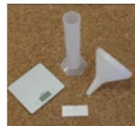
**Bestimmung des Hektolitergewichts** – mit Waagen, Trichter & 1 Liter-Messzylinder
