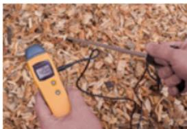
Feuchtigkeitsmessgerät für Holz & 600mm lange Sonde
