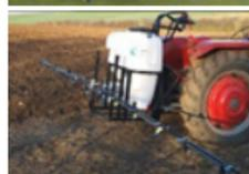
**Traktor-Anbauspritze Midi** – Ausführung für den professionellen Einsatz, Zapfwellenpumpe, Druckregler, 4 m-Gestänge, elektronische Steuerung, 10 m-Schlauchtrommel, Einspülvorrichtung
