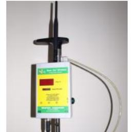
Der wasserdichte Barn Owl Wireless-Messfühler besteht aus einem batteriebetriebenen Funküberträger in einem nach IP65 klassifizierten Gehäuse mit digitalem Temperaturdisplay.
